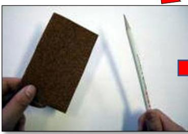
勾玉の内側のカーブは、鉛筆にヤスリを巻き付けながら削ると、きれいに削れます。
